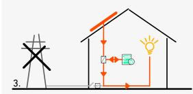
3. Une batterie de stockage avec option backup et fonctionnement en îlot, permet l'alimentation de votre maison en cas de coupure de courant via l'énergie stockée dans les batteries ainsi que le fonctionnement de l'installation photovoltaïque, quand l'ensoleillement est suffisant.
