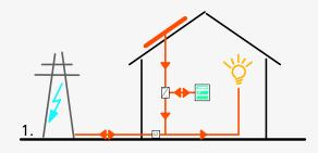
Cependant, en cas de coupure du réseau, la batterie ainsi que l'installation photovoltaïque se coupent pour des raisons de sécurité, afin d'éviter tout risque de réinjection dans le réseau.
